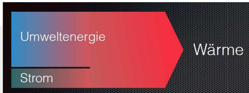
Durch die kostenfreie Umweltenergie können mit 1 kWh Strom je nach Bedingungen 3 bis 5 kWh Wärme erzeugt werden.
